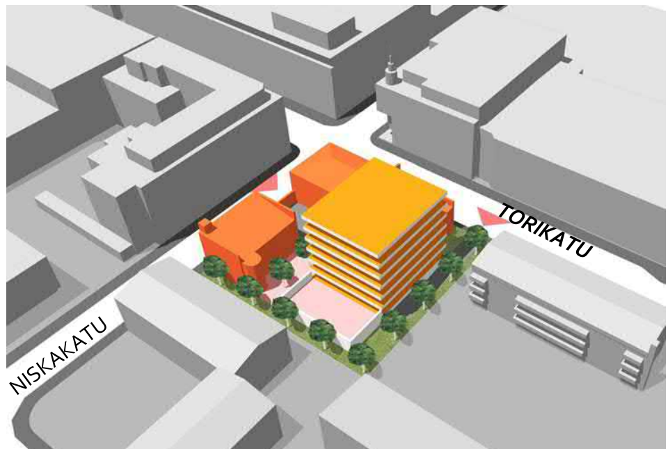
Ve3: Inari ja Jokela suojeltu muutoin, mutta Kino-Karjalan sali on purettu ja salin paikalle on sijoitettu uudisrakentamista (kuva Joensuun kaupunki, 2018). Ajo pihakannen ja rakennuksen alaisiin pysäköintitiloihin on Torikadun puolelta tontin pohjoisosasta
