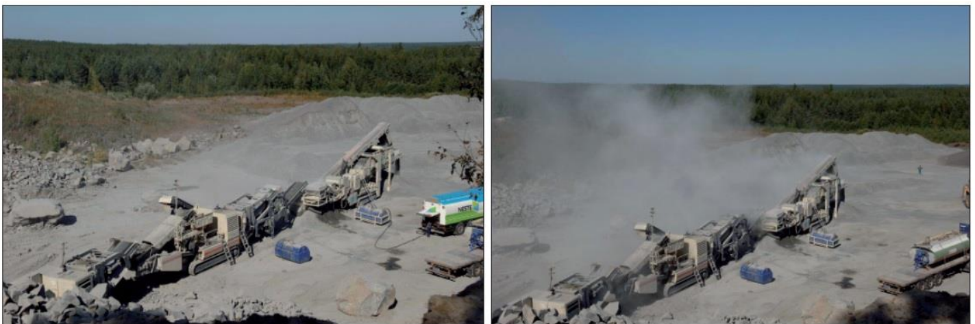
Kuva 14. Vesikastelun vaikutus pölyn syntymiseen murskauksessa. (Kuva: Metso 2010, Suomen ympäristö 25/2010)
