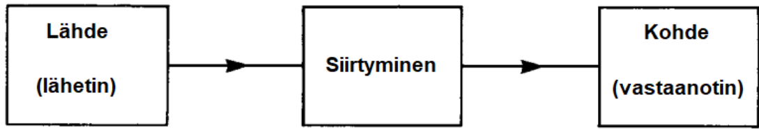
Kuva 1. Sähkömagneettisen häiriön kytkeytymisen perusrakenne
