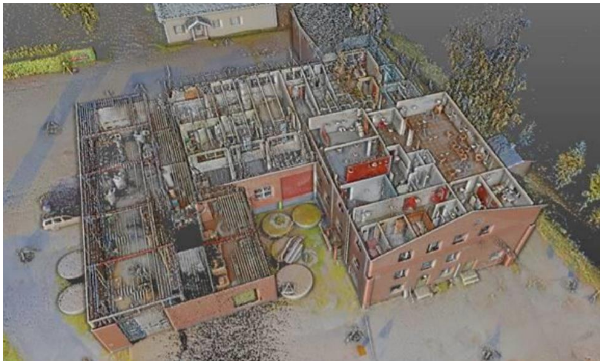
Kuva: 3D laserkeilauskuva Meijerirakennuksesta vuodelta 2021, kuvankäsittely Autodesk ReCap, Lähde: Aavakax Oy:n arkisto.
