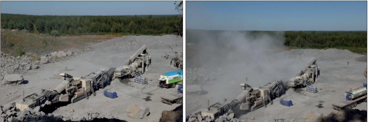
Kuva 8. Vesikastelun vaikutus pölyn syntymiseen murskauksessa. (Kuva: Metso 2010, Suomen ympäristö 25/2010)
