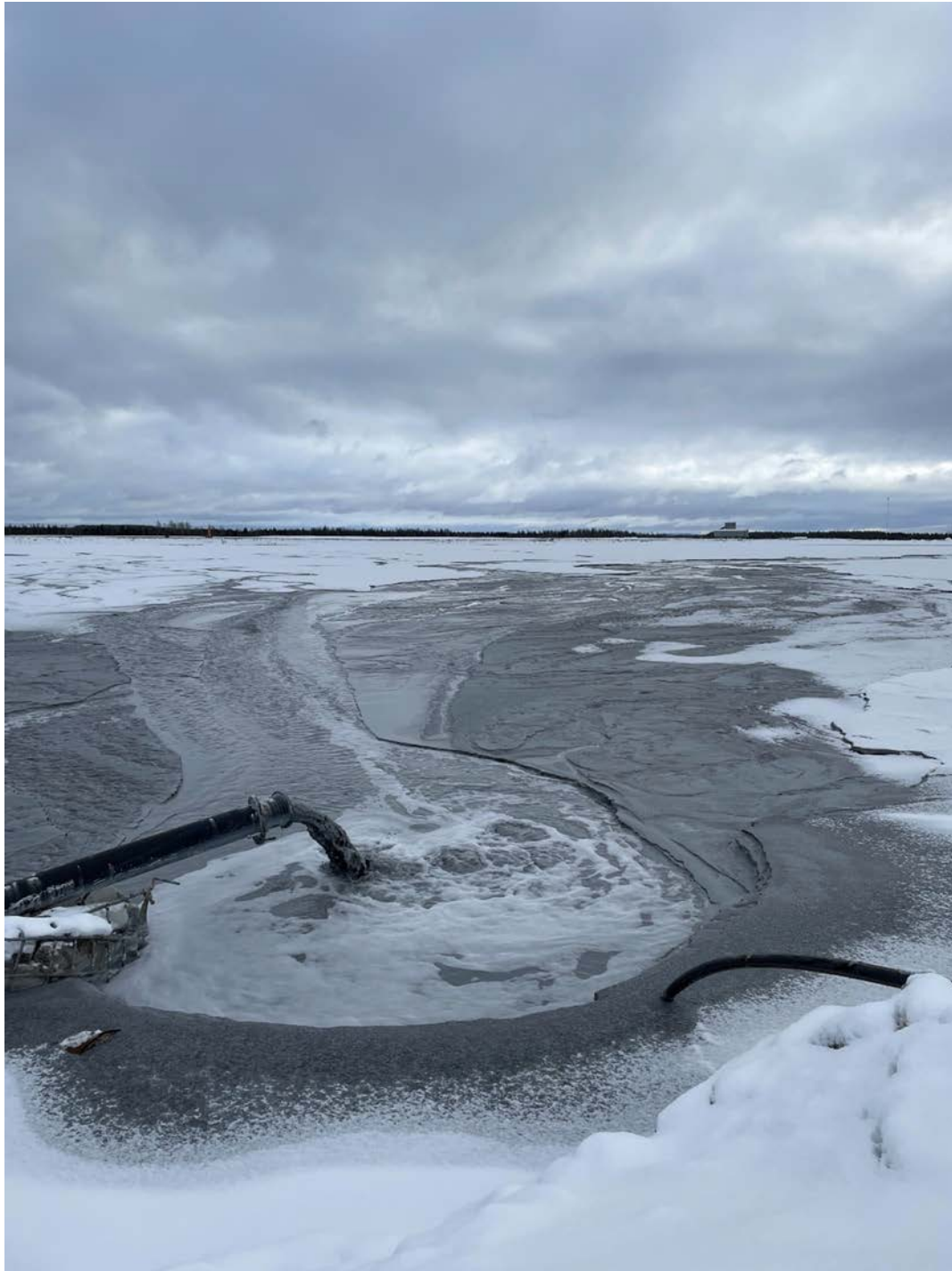
Kuva 3-10. Rikastushiekan läjitystä rikastushiekka-allas 1:llä.
