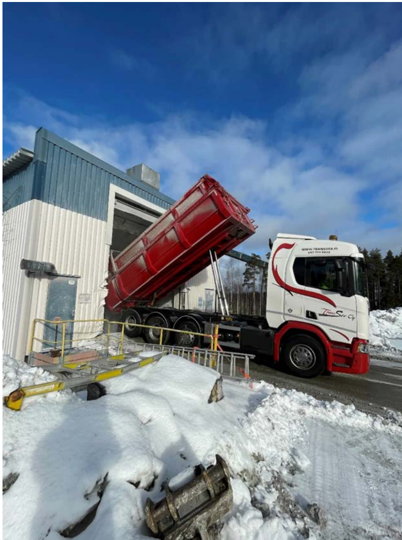
Kuva 3-4. Malmirekka kippaamassa malmikuormaa leukamurskan syöttimeen.
