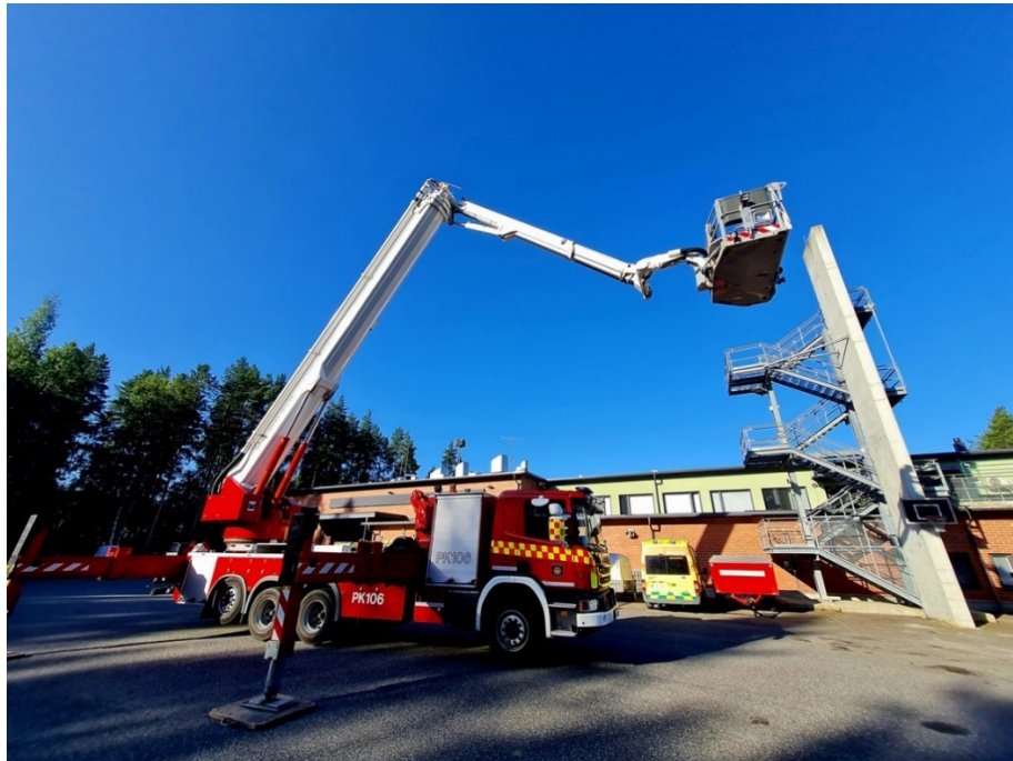
Kuva 5: Nostolava 106 harjoituksessa. Pelastuslaitos ylläpitää tarpeellista määrää erikoiskalustoa, joka vastaa alueella olevaan onnettomuusuhkaan. Nostolavalla varaudutaan pelastamaan ihmisiä korkealta ja sammuttamaan kattorakenteiden tulipaloja.
