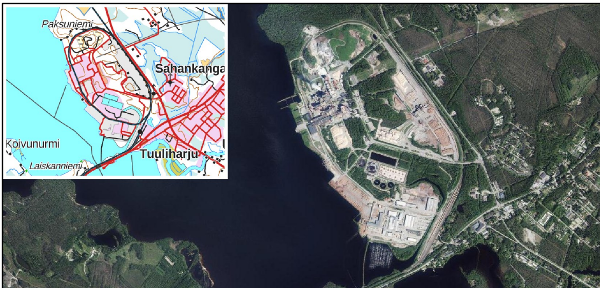
Kuva 33. Esimerkkialue Uimaharjusta. Alueella sijaitsee Stora Enson Enocellin tehdas. Sellun valmistusprosessit synnyttävät merkittäviä määriä hukkalämpöä, jota voidaan hyödyntää mm. kaukolämmöntuotannossa. Alueella on potentiaalia myös teollisen mittaluokan energiaratkaisuihin.
