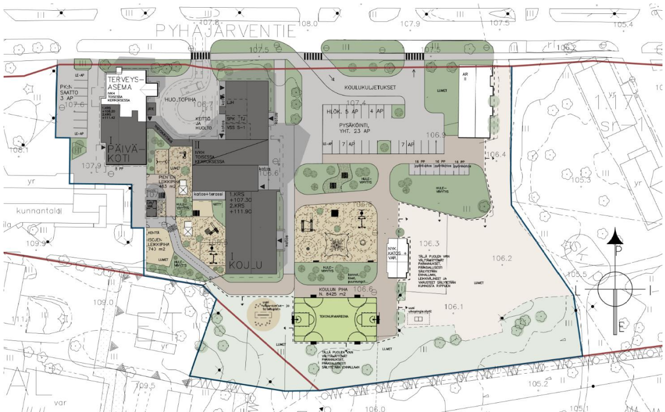
Kuva 15 Tontinkäyttösuunnitelma, haalealla esitetyt itä- ja eteläpuolen osat on esitetty säilytettävän ennallaan. Uusi leikkipiha sijaitsee Poukkuluoso-rakennuksen paikalla. Pyhäjärvitä on esitetty purettavaksi pohjoisen puolen asuinrakennuspiipeä lukuun ottamatta.
