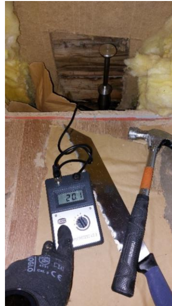
Kuva 17. Alaohjauspuussa mitattiin selkeästi koholla olevaa kosteutta.
