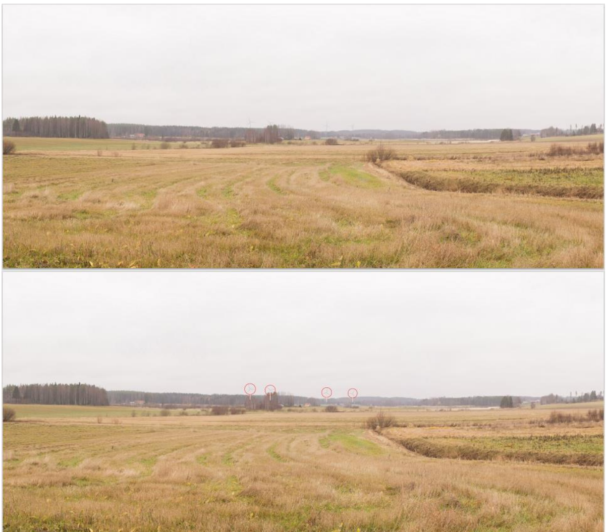
Kuva 9-6. Kaavaratkaisun mukaiset tuulivoimalat Kaatamo-Ristinkylän alueelta Saporomäestä lännen suuntaan katsottaessa (kuvauspiste 7). Etäisyys lähimpiin voimaloihin on noin 7,6 km. Havainnollisuuden vuoksi voimalat on esitetty alemmassa kuvassa ns. rautalankamallina.
